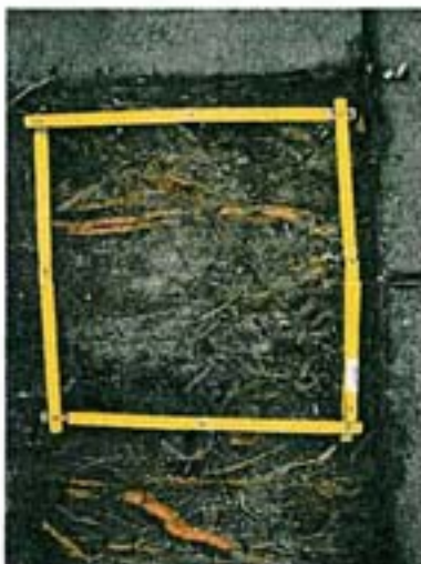
Abb. 9: Wurzelfilz mit ca. 90 % Deckung (Abstand 1,0 m vom Baum).
